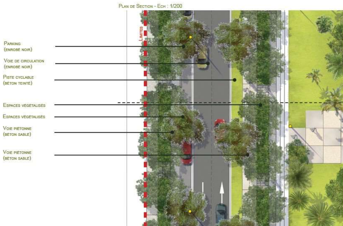
Figure 9 : Vue en plan de la voie restreinte
